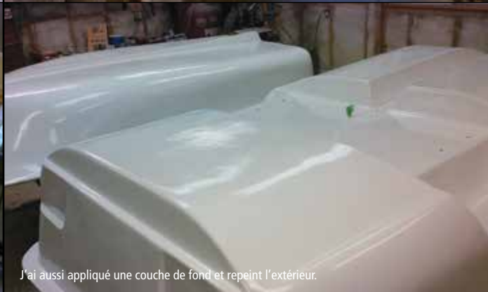
J'ai ensuite appliqué plusieurs couches de mastic de finition en polyester.
